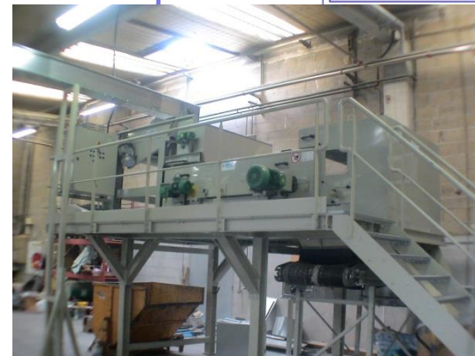
Wirbelstromabschneider Eddy current separator
